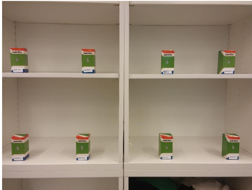
Figura 4.1. Disposición de los tags (cajitas) en la estantería inteligente
