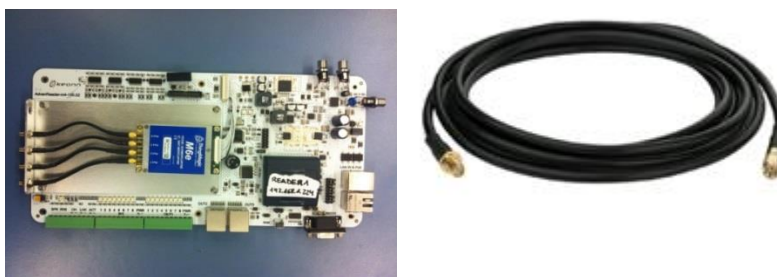
Figura 2.4. AdvanReader-100 i cablejat connexió antena
